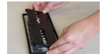
Posizionare la piastra di montaggio con i magneti nel telaio intercambiabile, spingendola verso il basso.
