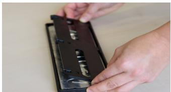
Montageplatte mit Magneten nach unten im Wechselrahmen platzieren.
