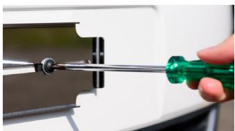
Die rostfreien Haltebleche sind mit Schrauben an die vorgesehenen Stellen an den Fahrzeugen zu montieren. Gummipuffer zwischen Halteblech und Stoßstange anbringen.
