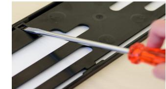
Portare tutti e quattro i dispositivi di bloccaggio a cursore nella posizione finale. In questo modo la targa verrà bloccata saldamente nel telaio intercambiabile.
