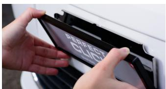
Wechselrahmen von unten nach oben bei den vorstehenden Laschen einführen. Auf seitliche Zentrierung achten. Prüfen, ob Wechselrahmen auf den Halteblechen richtig aufliegt.
