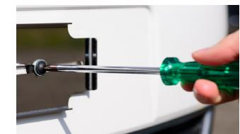
Le piastre di sostegno inossidabili devono essere fissate con viti nei punti previsti sul veicolo. Inserire l'ammortizzatore di gomma tra la piastra di sostegno e il paraurti.
