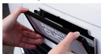
Introduisez le cadre interchangeable par le bas vers le haut au niveau des deux pattes qui dépassent. Veillez au centrage latéral. Vérifiez si le cadre interchangeable est bien en place sur les tôles de fixation.
